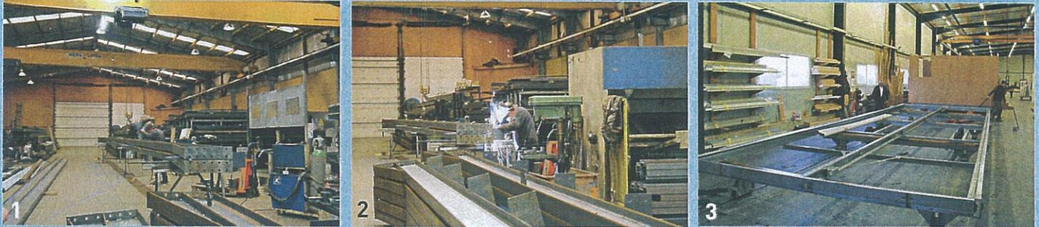
L'atelier sidérurgique réalise un châssis maison, selon les techniques du bâtiment. Ce cadre, fait de poutrelles d'acier galvanisé, ne craint pas la déformation. Porteur du futur mobil-home, il repose sur quatre roues - la plupart des fabricants n'en mettent que deux - afin d'offrir au « mobil » home toute sa mobilité et une meilleure portance. Il faut dire que les Nautilhome pèsent jusqu'à 1 000 kilos de plus que la plupart des modèles du marché !
